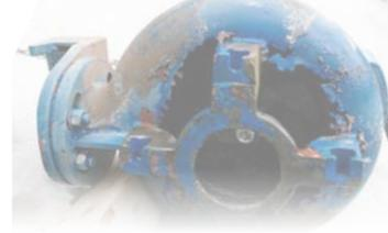
MetaLine® Serie 700 – Verschleißschutz für Pumpen & Förderanlagen
