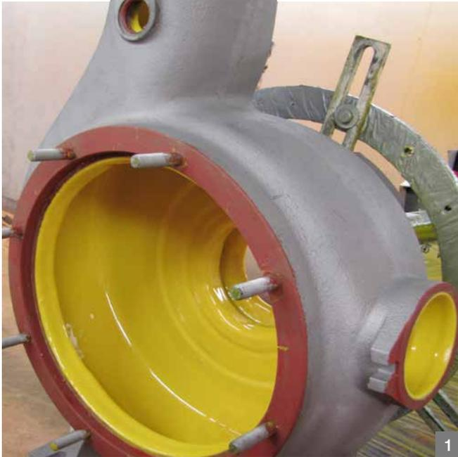
In einem einzigen Arbeitsgang – gieß- und sprühbare Verschleißschutz-Elastomere. Aufwendige, zerspanende Nachbearbeitungen können oftmals dauerhaft vermieden werden.
