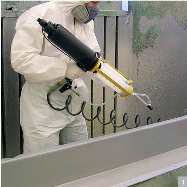
Elastomere Auskleidungen für die funktionelle Optimierung von Vibrationsrinnen. Teileschonung, Lärmreduktion, Förderverbesserung und Standzeitverlängerung. FDA-Zulassung für den Einsatz in der Pharma- und teilweise Lebensmittelindustrie.
